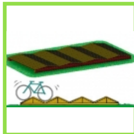
Rampa de badenes para bicicletas
